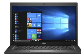
DELL Latitude 7480. Type de produit: Ordinateur portable, Format: Clapet. Famille de processeur: Intel® Core™ i5, Modèle de processeur: i5-6300U, Fréquence du processeur: 2,4 GHz. Taille de l'écran: 35,6 cm (14"). Mémoire interne: 8 Go, Type de mémoire interne: DDR4-SDRAM. Capacité totale de stockage: 256 Go, Supports de stockage: SSD. Modèle d'adaptateur graphique inclus: Intel® HD Graphics 520. Système d'exploitation installé: Windows 10 Pro. Couleur du produit: Noir. Poids: 1,36 kg
